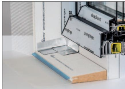
Einbauen der Fensterbankkeildämmplatten mit Abdichtungssystem (zweite wasserführende Dichtebene).
